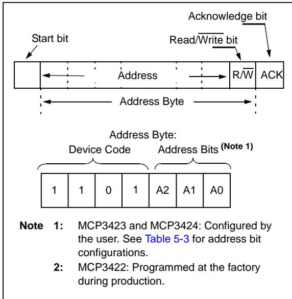
**FIGURE 5-1:** Address Byte.
