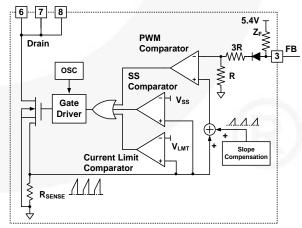
Figure 21. Soft-Start and Current-Limit Circuit
