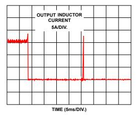
FIGURE 1. OVERCURRENT OPERATION
