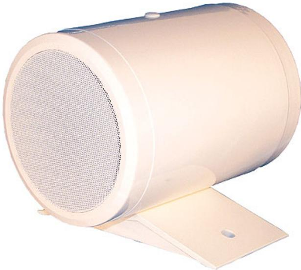
**Doppelt abstrahlender Gehäuselautsprecher** mit zylindrischem Kunststoffgehäuse (ABS) und stabilem Montagefuß (Aluminium). Bestückt mit zwei Breitbandlautsprechern und 100-V-Übertrager. Verdeckte Kabelführung unter dem Fuß möglich. Hohe Sprachverständlichkeit. Besonders geeignet für Korridore und Flure oder andere längliche Räume.
