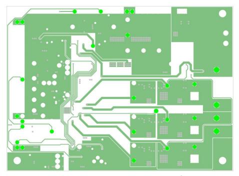
Figure 24. LV8968BB Evaluation Board Layout 3<sup>rd</sup> Layer
