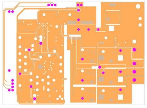
Figure 23. LV8968BB Evaluation Board Layout 2<sup>nd</sup> Layer
