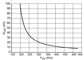
Figure 15. R<sub>OSC</sub> vs. F<sub>SW</sub>
