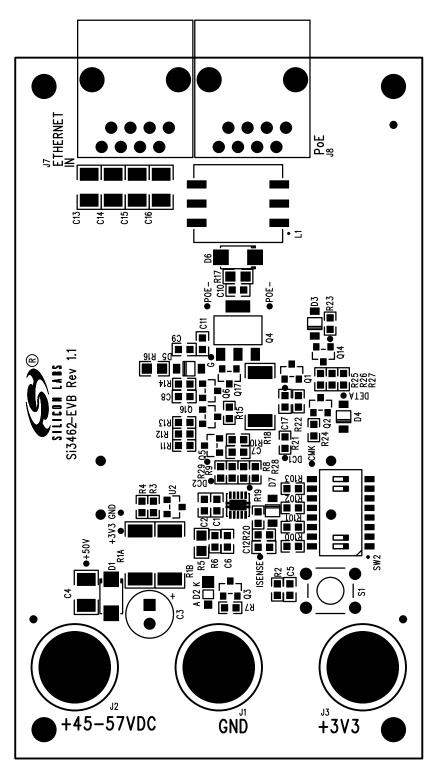
Figure 17. Si3462-EVB Top-Side Component Placement
