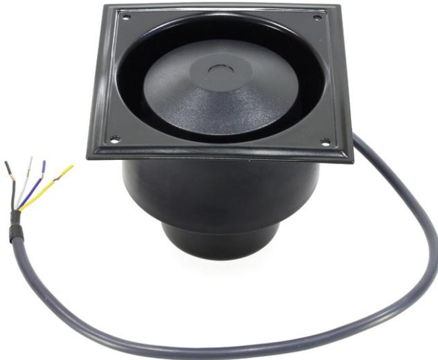
**Einbau-Druckkammerhorn-Lautsprecher** mit 100-V-Übertrager. Wasserfeste Ausführung. Gehäuse aus schwarz lackiertem Aluminium, Horneinsätze aus Polypropylen (PP). Hohe IP-Schutzklasse (IP 67), hoher Schalldruck und gute Sprachverständlichkeit. Durch die kompakten Abmessungen besonders für unauffällige Montage geeignet. Der Potenzialausgleich erfolgt über einen M6-Gewindestift auf der Gehäuserückseite. Der Anschluss erfolgt über eine vieradrige Schlauchleitung (0,5 m).
