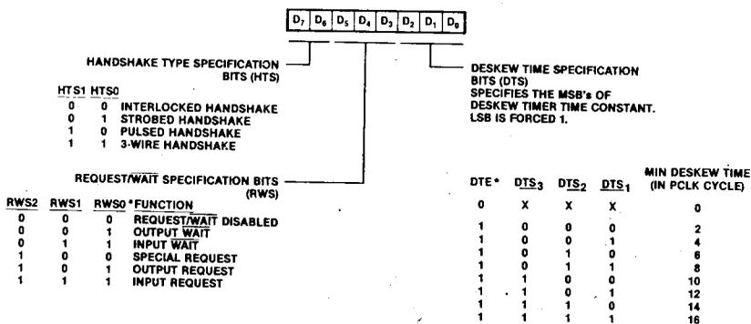
\*IN MODE SPECIFICATION REGISTER (SECTION 2.5.1)
