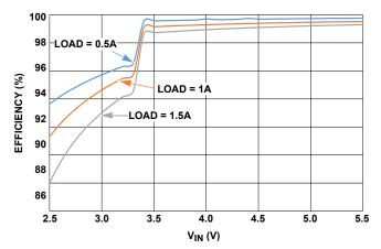
FIGURE 4. EFFICIENCY vs V<sub>IN</sub>, V<sub>OUT</sub> = 3.3V
