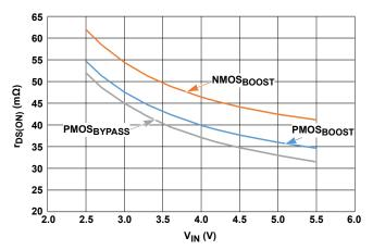
FIGURE 17. MOS  $r_{DS(ON)}$  vs  $V_{IN}$
