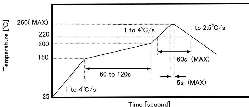
推奨温度プロファイルを提示しておりますが、製品の品質保護の為、ピーク温度は低く、リフローの冷却時間は長く、冷却温度勾配は出来るだけゆるやかにすることをお勧めします。またリフロー装置の仕様及び基板の大きさ、レイアウト等により、デバイスへの熱の伝わり方に差が出る可能性がありますので、個別の評価をお願いします。
