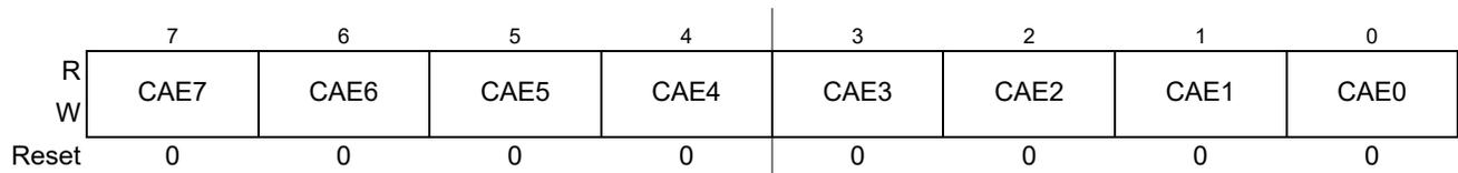
Figure 13-7. PWM Center Align Enable Register (PWMCAE)
