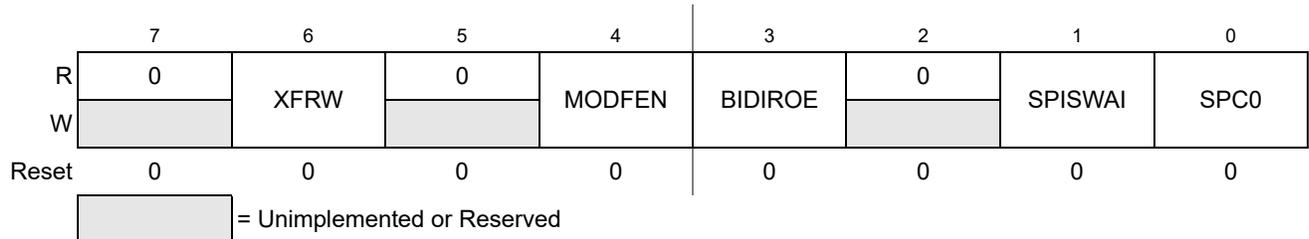
**Figure 15-4. SPI Control Register 2 (SPICR2)**
