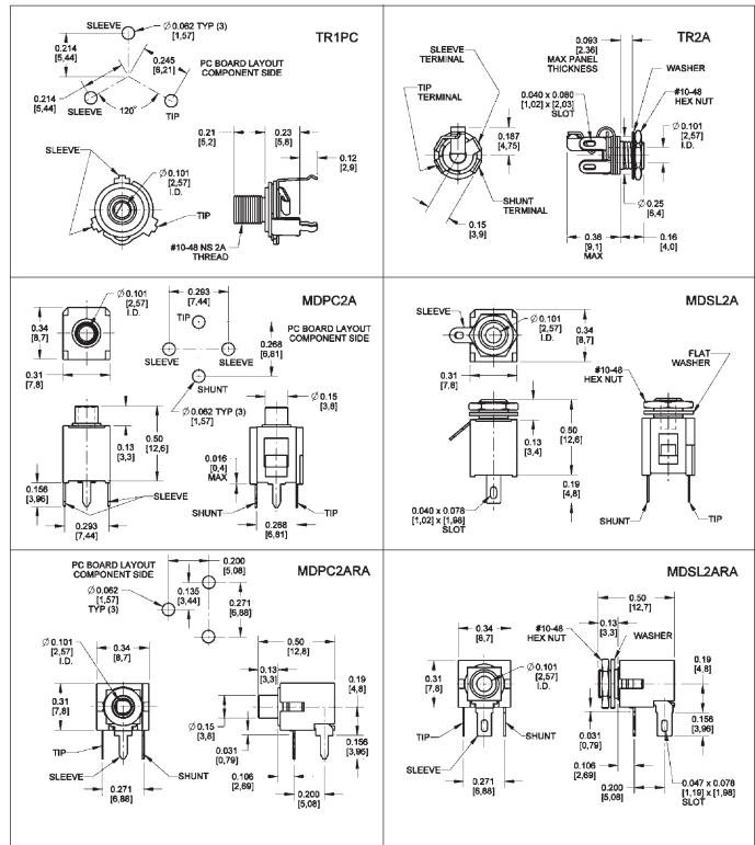
DIMENSIONS ARE FOR REFERENCE ONLY  $\frac{\text{lnch}}{(\text{mm})}$
