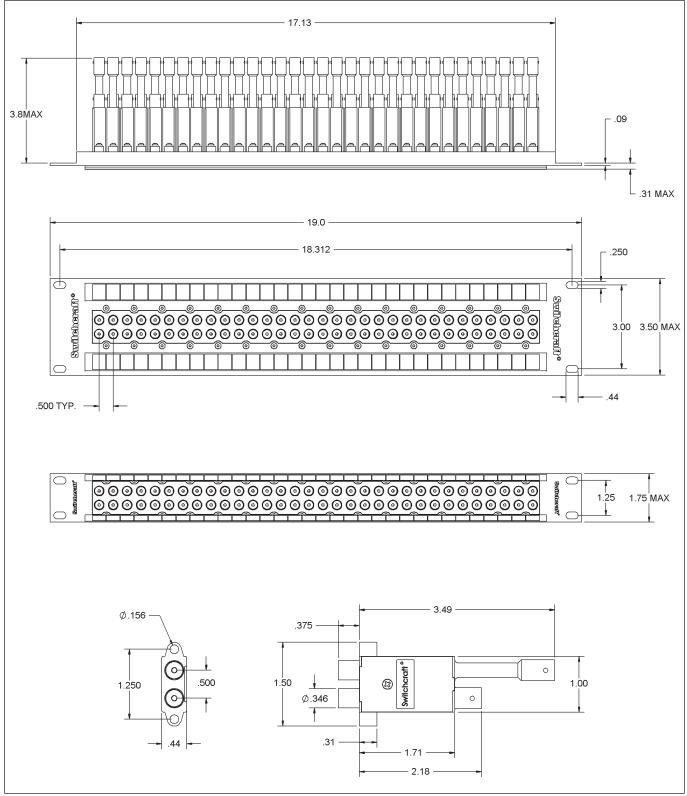
DIMENSIONS ARE FOR REFERENCE ONLY  $\frac{\text{lnch}}{(\text{mm})}$
