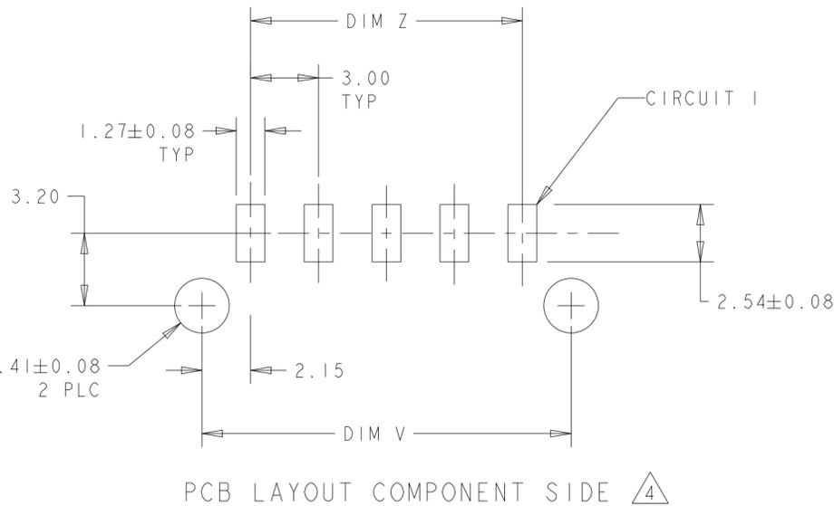
PCB LAYOUT COMPONENT SIDE 4
