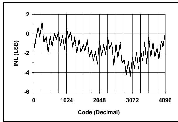
**FIGURE 2-10:** INL vs. Code (MCP4922).
