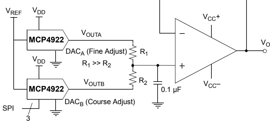
$$V_{OUTA} = V_{REF_A} G_A \frac{D_A}{2^{12}}$$
