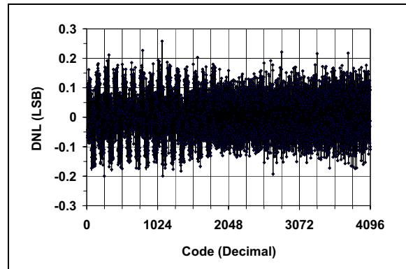
**FIGURE 2-1:** DNL vs. Code (MCP4922).
