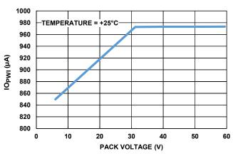
FIGURE 18. OPEN-WIRE TEST CURRENT vs PACK VOLTAGE (1mA SETTING)
