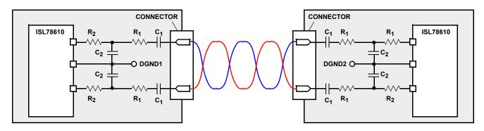
FIGURE 48. ISL78610 DAISY CHAIN CIRCUIT IMPLEMENTATION
