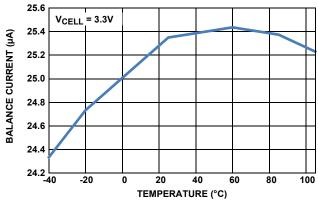
FIGURE 16. BALANCE CURRENT vs TEMPERATURE
