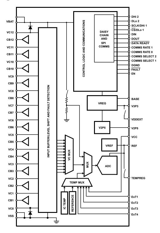
FIGURE 2. BLOCK DIAGRAM
