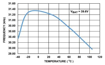
FIGURE 23. 32kHz OSCILLATOR FREQUENCY vs TEMPERATURE
