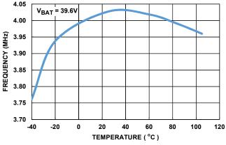
FIGURE 21. 4MHz OSCILLATOR FREQUENCY vs TEMPERATURE
