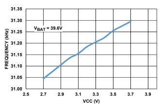
FIGURE 24. 32kHz OSCILLATOR FREQUENCY vs V<sub>CC</sub>
