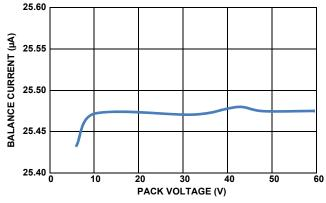
FIGURE 15. BALANCE CURRENT vs PACK VOLTAGE
