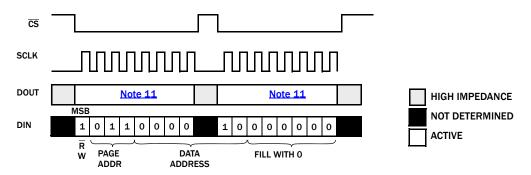
FIGURE 61. SPI FULL DUPLEX (STAND-ALONE) MEASURE COMMAND EXAMPLE: EXT4 VOLTAGE
