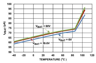
FIGURE 29. PACK VOLTAGE SUPPLY CURRENT vs TEMPERATURE AT 6V, 39.6V, 60V (STAND-ALONE MODE)
