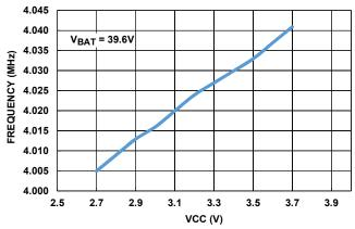
FIGURE 22. 4MHz OSCILLATOR FREQUENCY vs V<sub>CC</sub>
