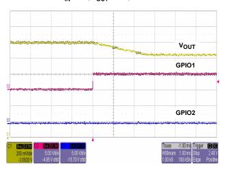
FIGURE 10. NEGATIVE VOLTAGE MARGINING SLEW TIME
