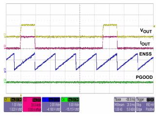
FIGURE 7. OVERCURRENT HICCUP MODE
