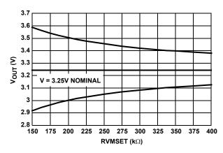
FIGURE 9. CHANGE IN OUTPUT VOLTAGE FOR VARIOUS RESISTORS
