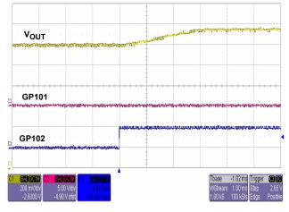
FIGURE 11. POSITIVE VOLTAGE MARGINING SLEW TIME
