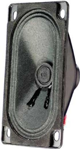
**Magnetisch abgeschirmter 5 x 9 cm (2" x 3,5")** Breitbandlautsprecher mit gutem Wirkungsgrad und ausgeglichenem Frequenzgang mit klarer Hochtonwiedergabe. Minimale Einbauabmessungen durch Verwendung eines Neodym-Magnetsystems. Zu den Anwendungsbereichen zählen Einbaulösungen auf geringstem Raum in Fernsehern sowie in PCs.
