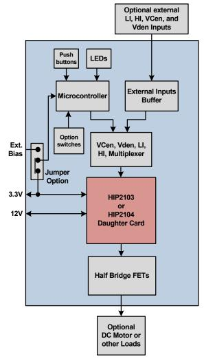
FIGURE 2. HIP2103\_4MBEVAL1Z, BLOCK DIAGRAM
