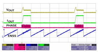
FIGURE 10. TYPICAL OVERCURRENT HICCUP MODE
