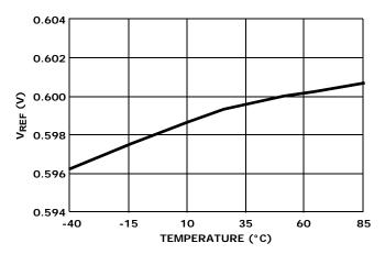
FIGURE 1. V<sub>REF</sub> vs TEMPERATURE
