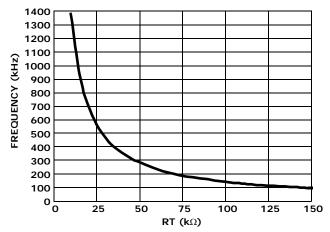
FIGURE 8. OSCILLATOR FREQUENCY vs RT
