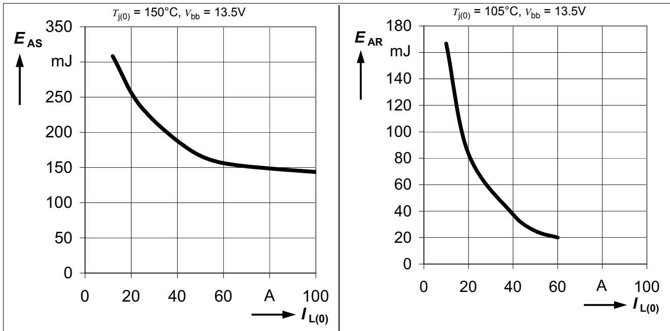
Figure 11 Maximum energy dissipation<sup>1) 2)</sup>
