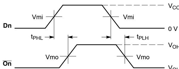
**WAVEFORM 1 – PROPAGATION DELAYS**
