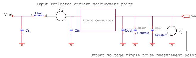
$$Cs=270\mu F \cdot 1 \quad L_{\text{test}}=1.4\mu H \quad Cin=270\mu F \cdot 3 \quad Cout=680\mu F \cdot 4$$
