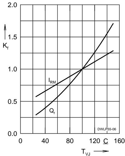
Fig. 4 Dynamic parameters  $Q_r$ ,  $I_{RM}$  versus  $T_{VJ}$
