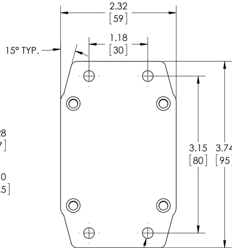
GASKET (NOT INSTALLED) MOLDED SILICONE GRAY
