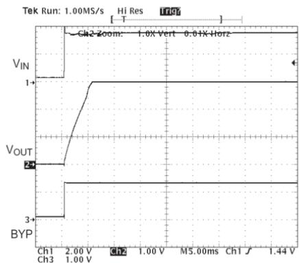
Fig. 18: Fast  $V_{IN}$ ,  $C_{OUT}=1000\mu F$ ,  $I_o=500mA$
