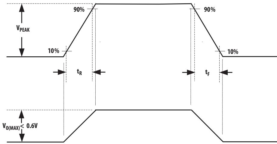
$$\frac{dV_o}{dt} = \frac{(0.8)V_{PEAK}}{t_R} \quad \text{OR} \quad \frac{(0.8)V_{PEAK}}{t_F}$$
