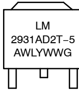
D2PAK D2T SUFFIX CASE 936
