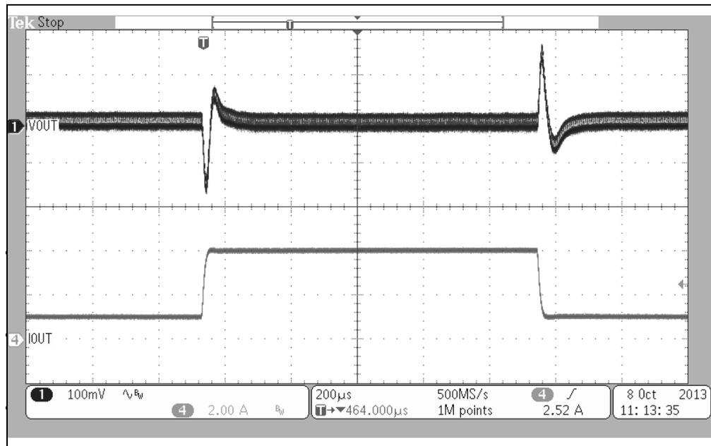
**FIGURE C-5:** Step Load ( $V_{IN} = 24V$ ).
