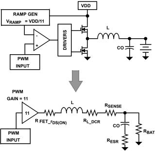
FIGURE 18. SMALL SIGNAL AC MODEL
