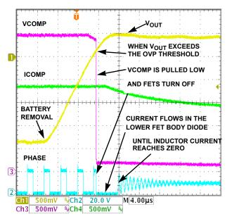
FIGURE 17. OVERVOLTAGE PROTECTION IN ISL6256
