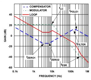
FIGURE 24. ASYMPTOTIC BODE PLOT OF THE VOLTAGE CONTROL LOOP GAIN
