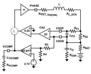
FIGURE 22. VOLTAGE CONTROL LOOP
