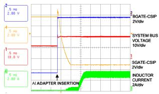
FIGURE 15. AC ADAPTER INSERTION
