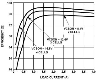
FIGURE 7. SYSTEM EFFICIENCY vs CHARGE CURRENT
