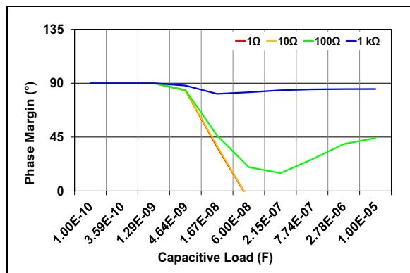
**FIGURE 2-25:**  $R_{ISO}$  vs.  $C_{LOAD}$ , 4.096V
