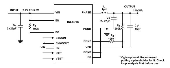
FIGURE 2. TYPICAL APPLICATION DIAGRAM - SINGLE CHIP 8A
