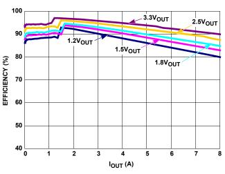
FIGURE 7. EFFICIENCY vs LOAD (1MHz 5V<sub>IN</sub> PFM)
