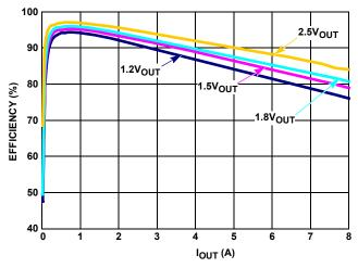
FIGURE 4. EFFICIENCY vs LOAD (1MHz 3.3V<sub>IN</sub> PWM)
