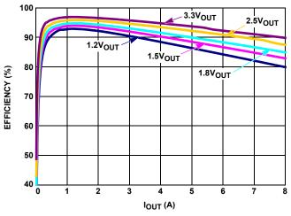
FIGURE 6. EFFICIENCY vs LOAD (1MHz 5V<sub>IN</sub> PWM)
