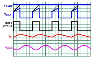
FIGURE 32. PWM OPERATION WAVEFORMS
