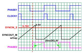
FIGURE 35. SYNCHRONIZATION WAVEFORMS
