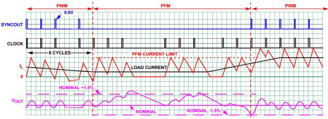
FIGURE 33. SKIP MODE OPERATION WAVEFORMS
