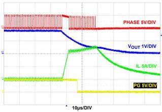
FIGURE 30. OUTPUT SHORT-CIRCUIT
