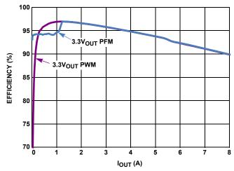
FIGURE 1. EFFICIENCY T = +25°C V<sub>IN</sub> = 5V
