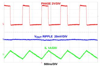
FIGURE 16. STEADY STATE OPERATION AT NO LOAD (PWM)
