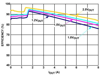
FIGURE 5. EFFICIENCY vs LOAD (1MHz 3.3V<sub>IN</sub> PFM)
