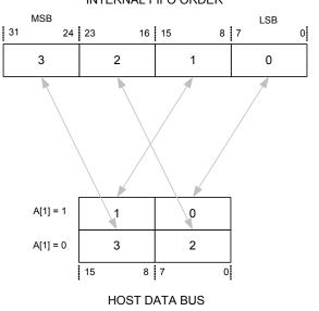
Figure 3.9 FIFO Access Byte Ordering
