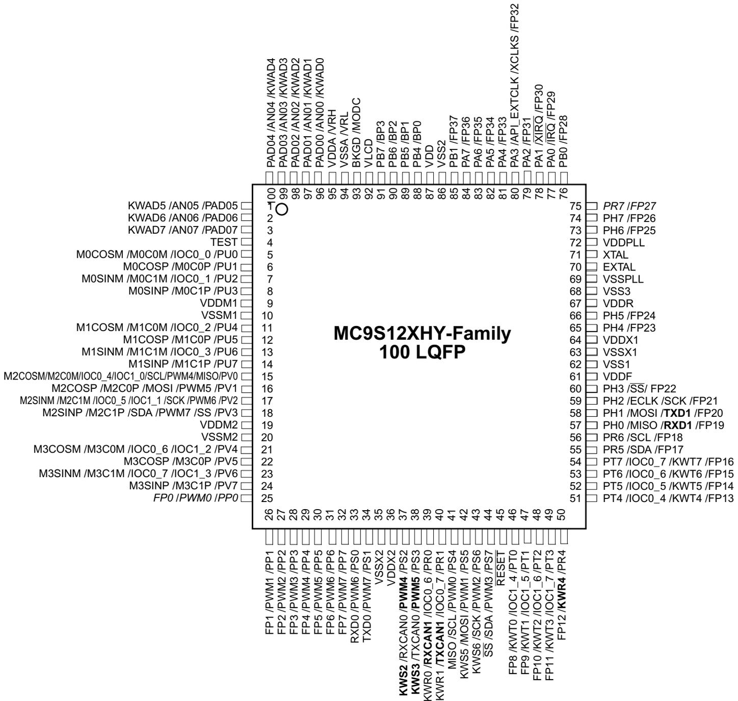
Figure 1-4. MC9S12XHY-Family 100LQFP pinout
