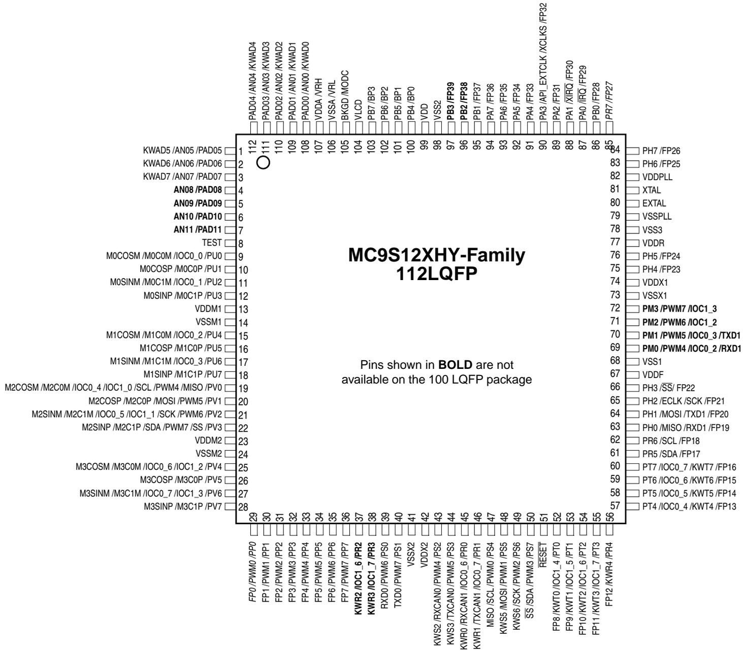
Figure 1-3. MC9S12XHY-Family 112 LQFP pinout
