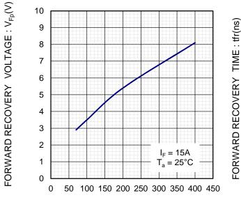
RATE OF CHANGE OF CURRENT : di/dt(A/ $\mu$ s) di/dt-V<sub>Fp</sub> CHARACTERISTICS
