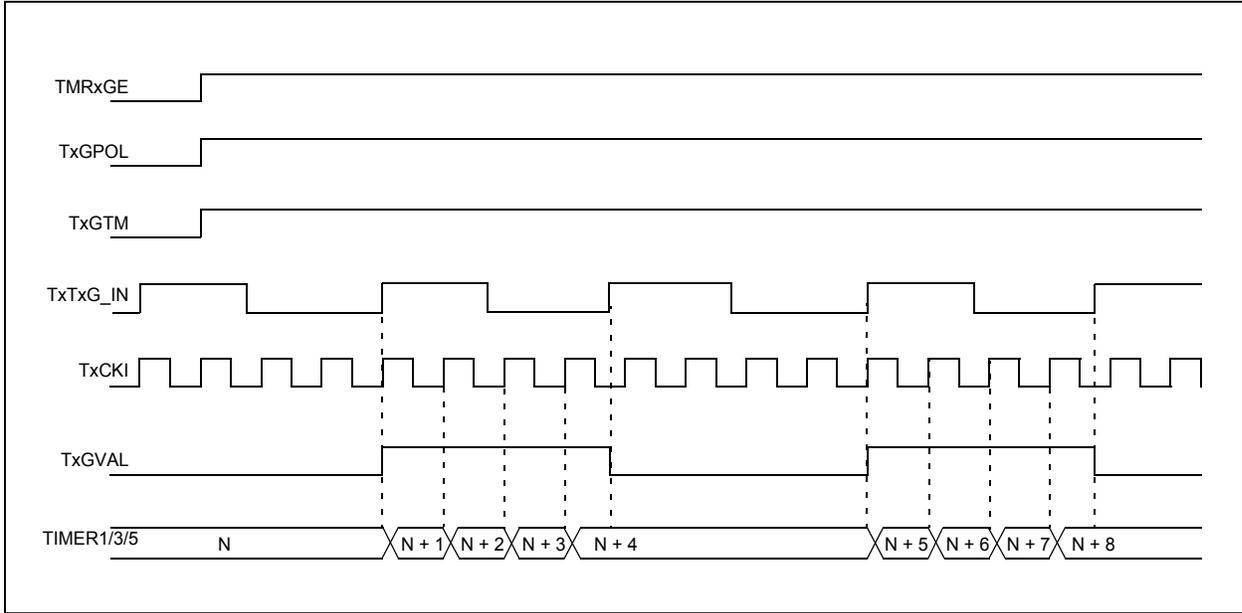
**FIGURE 21-6: TIMER1/3/5 GATE SINGLE-PULSE MODE**
