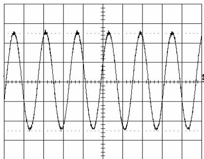
Output voltage ripple (20mV/div.) at:
