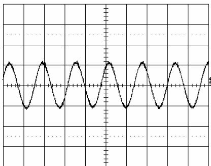
Output voltage ripple (20mV/div.) at:
