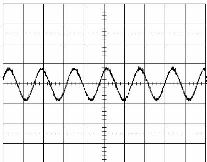
Output voltage ripple (20mV/div.) at:
