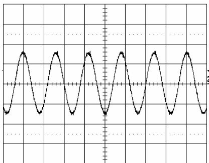
Output voltage ripple (20mV/div.) at:
