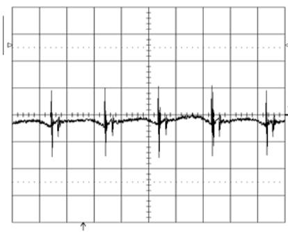
Output voltage ripple (20mV/div.) at:
