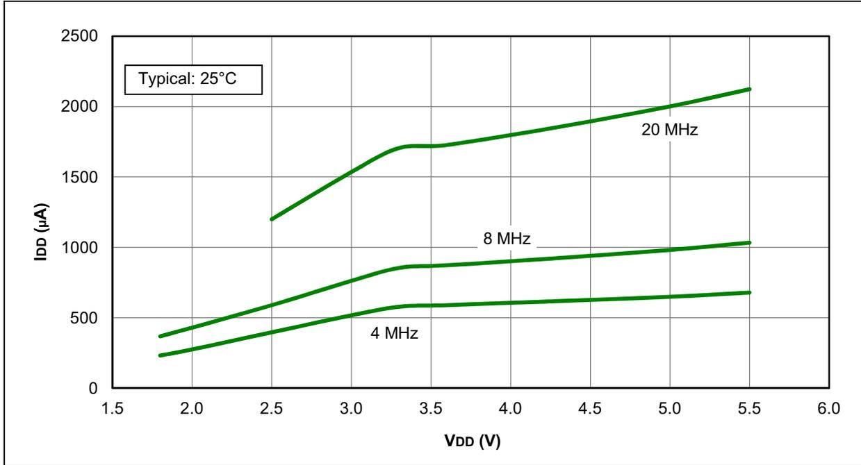
FIGURE 31-30: I<sub>DD</sub> MAXIMUM, HS OSCILLATOR, PIC12F1822 AND PIC16F1823 ONLY
