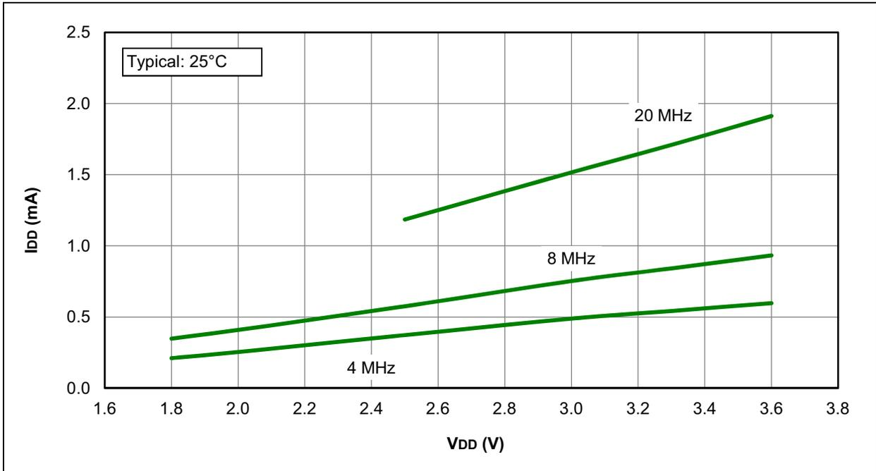
FIGURE 31-28: I<sub>DD</sub> MAXIMUM, HS OSCILLATOR, PIC12LF1822 AND PIC16LF1823 ONLY
