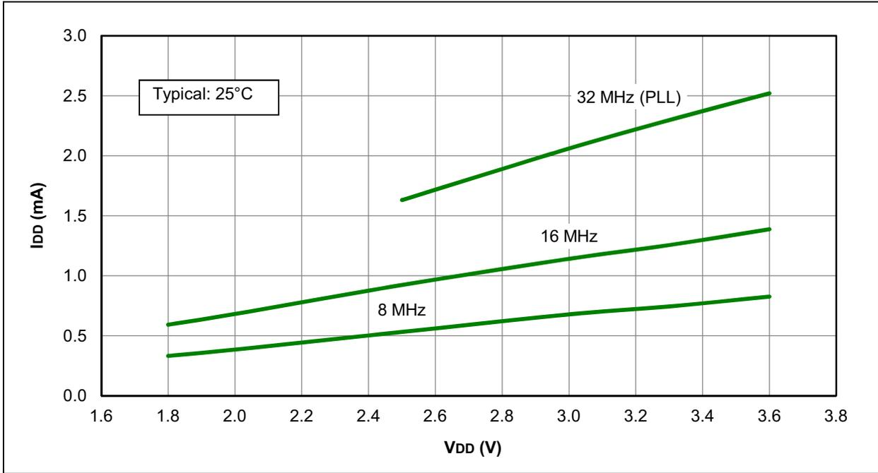
**FIGURE 31-16: I<sub>DD</sub> MAXIMUM, EC OSCILLATOR, HIGH-POWER MODE, PIC12LF1822 AND PIC16LF1823 ONLY**
