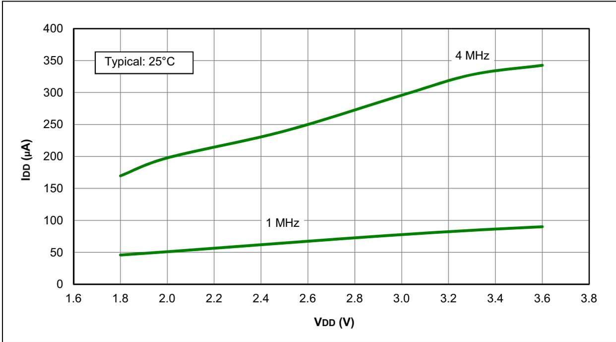
**FIGURE 31-12: I<sub>DD</sub> MAXIMUM, EC OSCILLATOR, MEDIUM-POWER MODE, PIC12LF1822 AND PIC16LF1823 ONLY**
