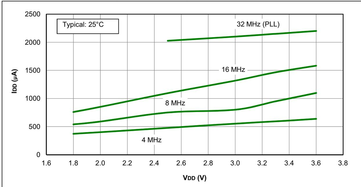
FIGURE 31-24: I<sub>DD</sub> MAXIMUM, HFINTOSC MODE, PIC12LF1822 AND PIC16LF1823 ONLY
