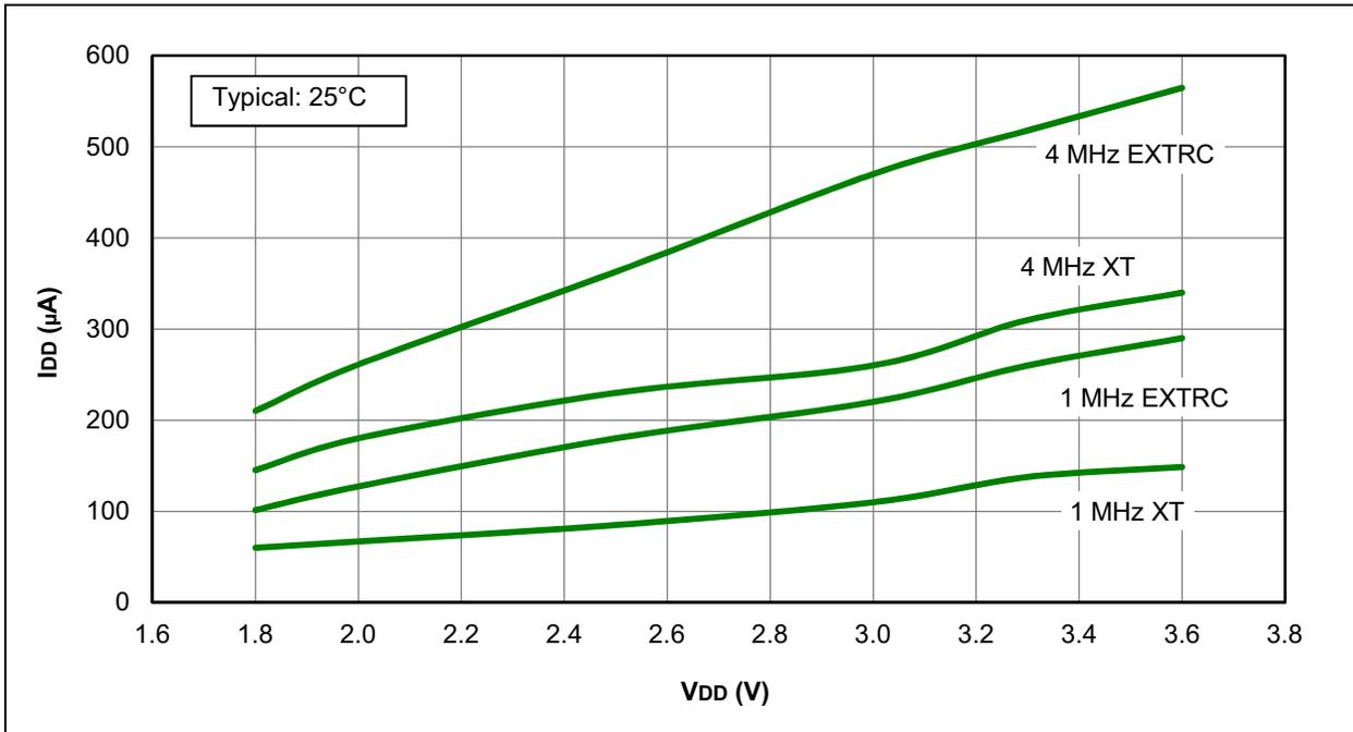
**FIGURE 31-4: I<sub>DD</sub> MAXIMUM, XT AND EXTRC OSCILLATOR, PIC12LF1822 AND PIC16LF1823 ONLY**
