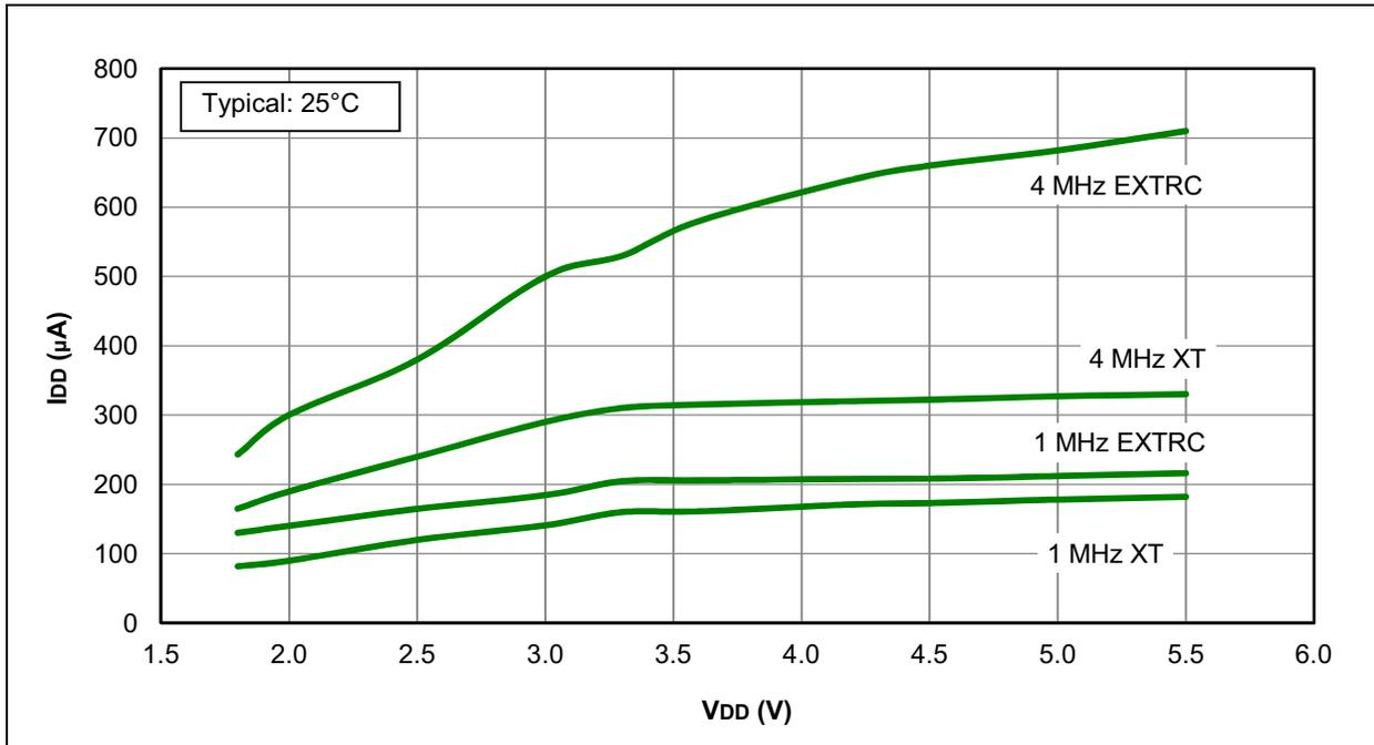
FIGURE 31-6: I<sub>DD</sub> MAXIMUM, XT AND EXTRC OSCILLATOR, PIC12F1822 AND PIC16F1823 ONLY
