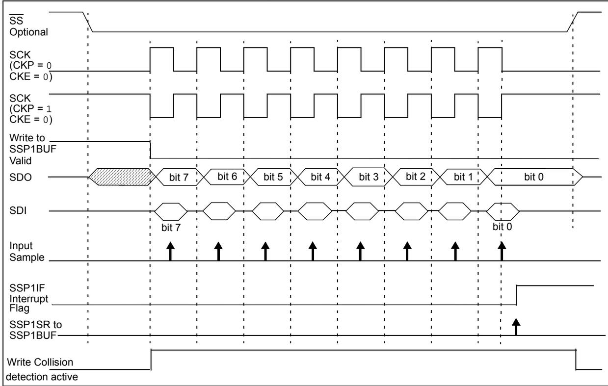
**FIGURE 25-10: SPI MODE WAVEFORM (SLAVE MODE WITH CKE = 1)**
