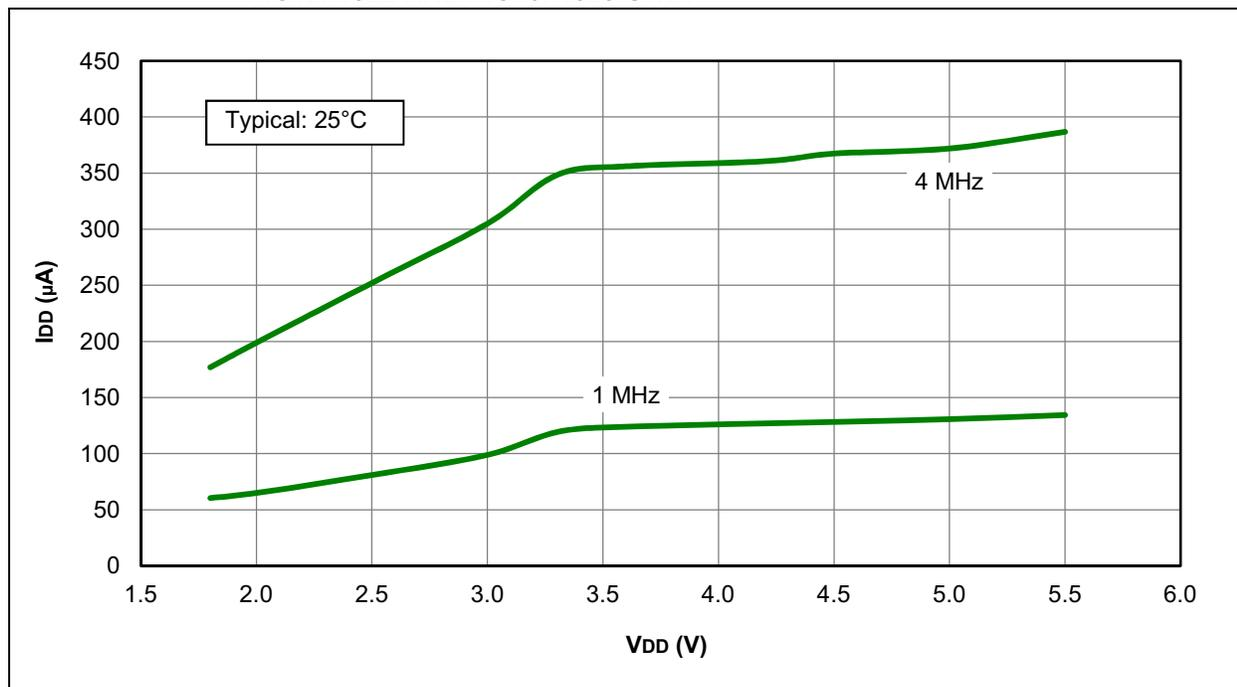
**FIGURE 31-14: I<sub>DD</sub> MAXIMUM, EC OSCILLATOR, MEDIUM-POWER MODE, PIC12F1822 AND PIC16F1823 ONLY**
