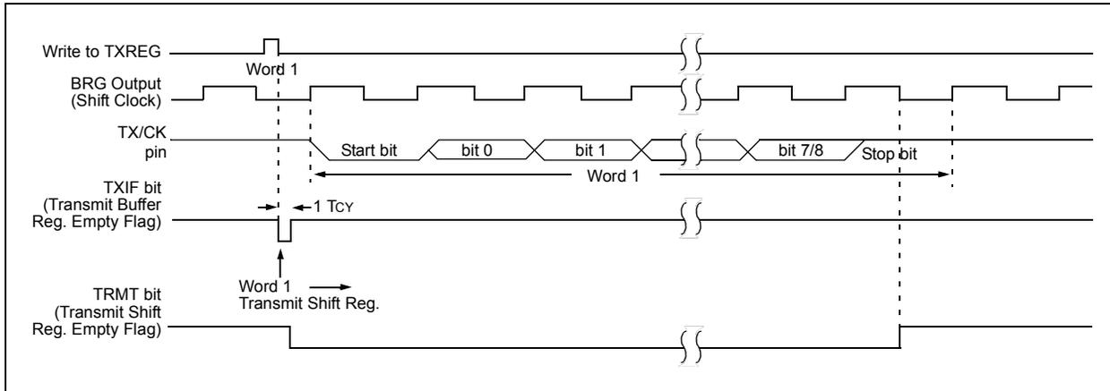
**FIGURE 26-4: ASYNCHRONOUS TRANSMISSION (BACK-TO-BACK)**
