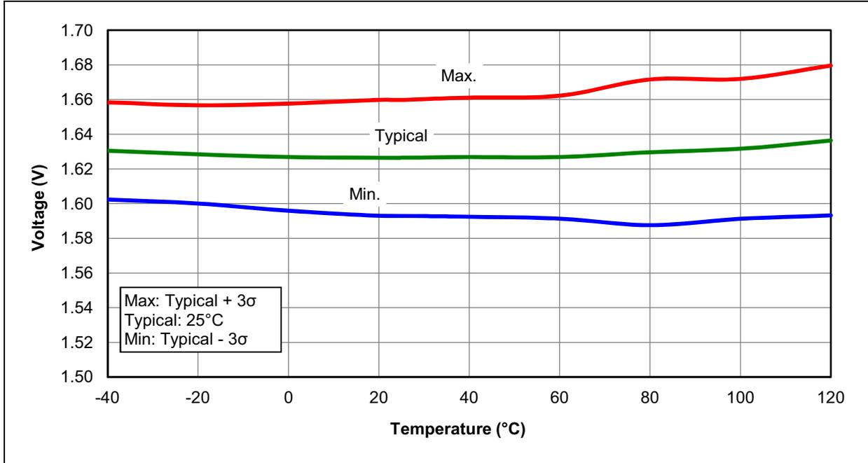
FIGURE 31-45: POR REARM VOLTAGE, PIC12F1822 AND PIC16F1823 ONLY
