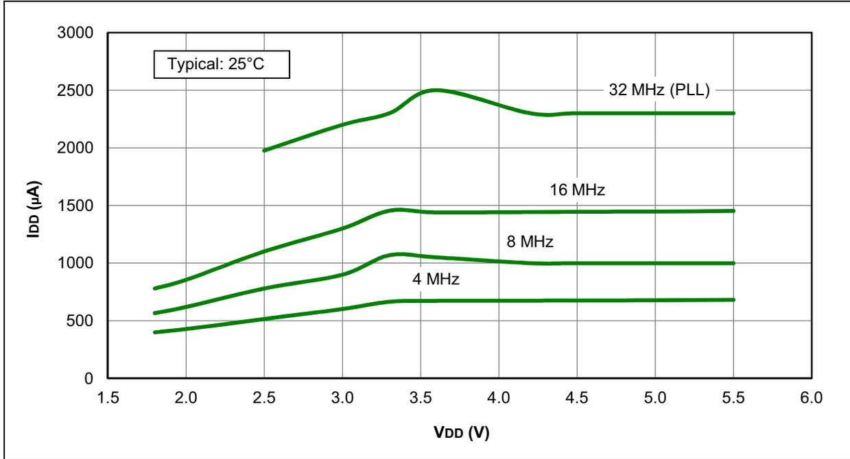
FIGURE 31-26: I<sub>DD</sub> MAXIMUM, HFINTOSC MODE, PIC12F1822 AND PIC16F1823 ONLY
