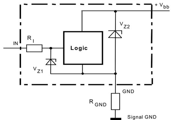
$V_{Z1}=6.1V$  typ.,  $V_{Z2}=V_{bb(AZ)}=62V$  min.,
