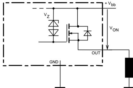
$V_{ON}$  clamped to 59V min.
