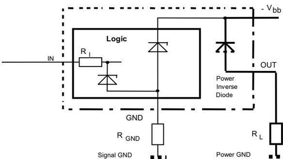
$R_{GND}=150\Omega$ ,  $R_I=3.5\text{ k}\Omega$  typ.,
