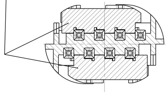
2.Kontaktsicherung in Endraststellung
