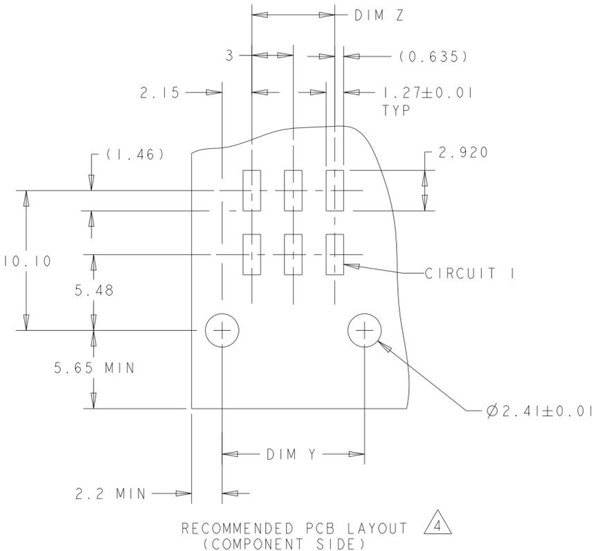
RECOMMENDED PCB LAYOUT (COMPONENT SIDE) 4
