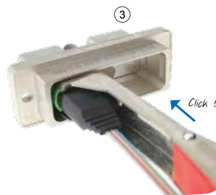
① Présenter le connecteur MPO face au module et le pousser à l'intérieur jusqu'au clic de verrouillage
