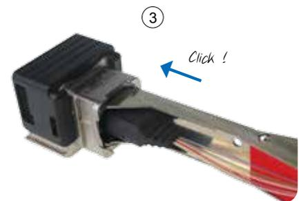
① Présenter le connecteur MPO face au module et le pousser à l'intérieur jusqu'au clic de verrouillage
