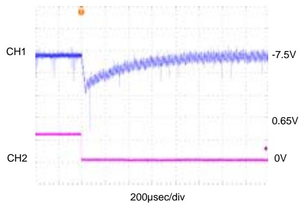
CH1:VOUT<sub>2</sub> , AC-COUPLED ,20mV/div
