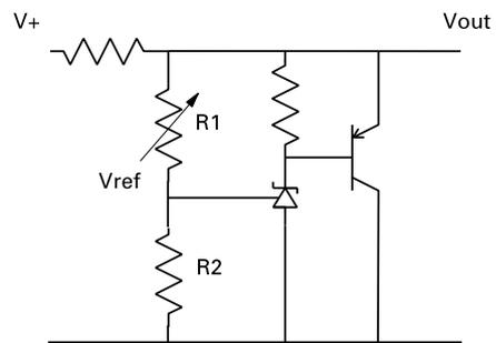
$$V_{out} = \left(1 + \frac{R1}{R2}\right) V_{ref}$$
