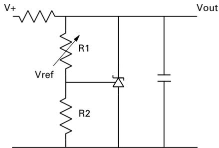
$$V_{out} = \left(1 + \frac{R1}{R2}\right) V_{ref}$$
