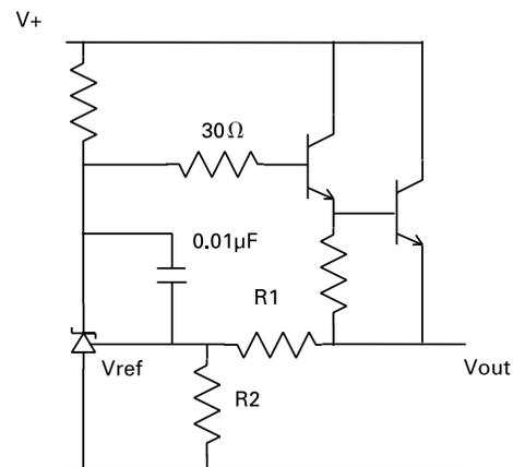
$$V_{out} = \left(1 + \frac{R1}{R2}\right) V_{ref}$$
