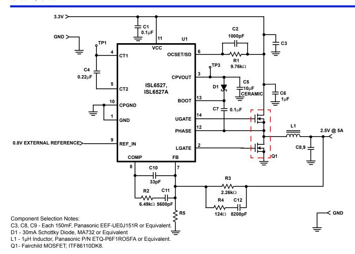
FIGURE 8. 3.3V TO 2.5V 5A DC/DC CONVERTER
