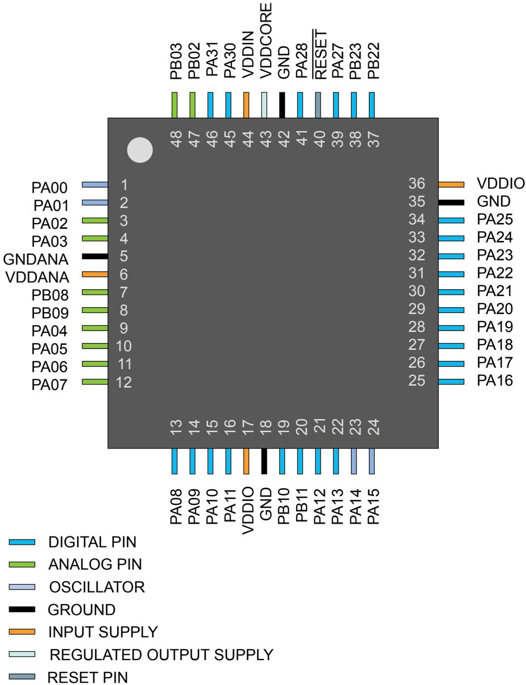
5.3 SAM DA1E - QFN32 / TQFP32
