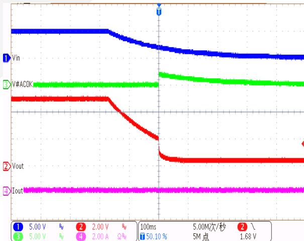
**VIN Power ON ( $V_{IN}=5V$ ,  $R_{Load}=1.6ohm$ )**
