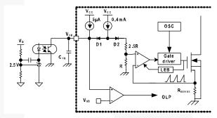
Figure 16. Pulse-Width-Modulation Circuit
