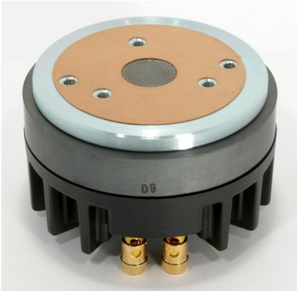
**Professioneller 1"-Treiber** mit Titankalotte, der zusammen mit dem Exponentialhorn M 300 im Mitteltonbereich ab 800 Hz einsetzbar ist. Die 40-mm-Schwingspule und das wuchtige Magnetsystem garantieren dieser Treiber-Horn-Kombination die für den Profibereich geforderte Verbindung von enormer Belastbarkeit bei extrem hohem Wirkungsgrad. Der sehr lineare Frequenzgang dieser Treiber-Horn-Kombination bietet auch vielfältige Einsatzmöglichkeiten im High-End-Bereich.
