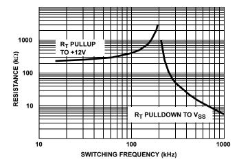
FIGURE 4. RT RESISTANCE vs FREQUENCY
