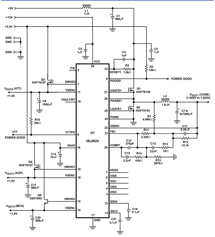
FIGURE 14. TYPICAL APPLICATION CIRCUIT
