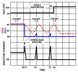
FIGURE 8. OVERCURRENT OPERATION
