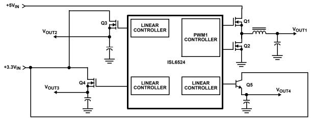
FIGURE 2. SIMPLIFIED POWER SYSTEM DIAGRAM
