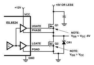
FIGURE 13. UPPER GATE DRIVE - DIRECT VCC DRIVE
